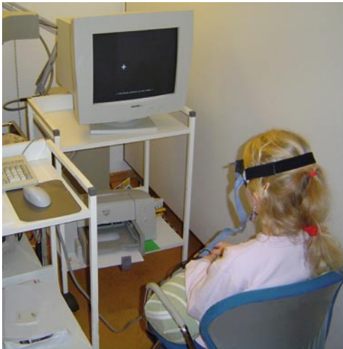
Abb. 3 ▲ a, b Blickmotorikmessung mit Infrarotreflexionsokulographie
